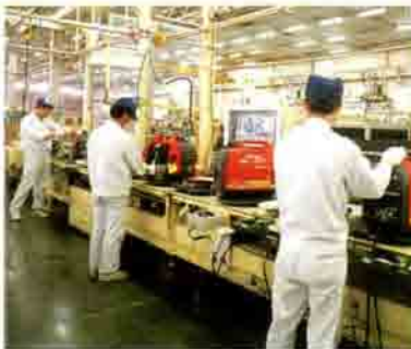
携帯用発電機 祭りやイベントのときに、屋台の裏側で見かける発電機。小型・軽量で、いつでもどこでも電気をつくれる高い信頼性は、電磁鋼板の積層技術や巻線技術などに支えられている。
